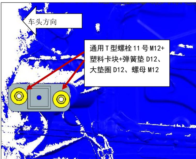
(6) 装后顶车支架：把后顶车支架装在对应位置上，先用 T 型螺栓连接起来（见下图），然后用对应弹簧垫、大垫片、螺母连接；左右两边安装方法一致（安装简图如下）
