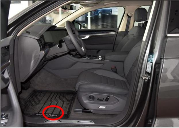
左踏板电机布线：掀开驾驶室垫脚海绵后，可看见车底穿线孔
