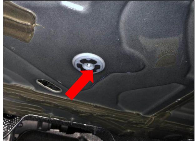
左踏板电机布线：如图此处孔位为左穿线孔
